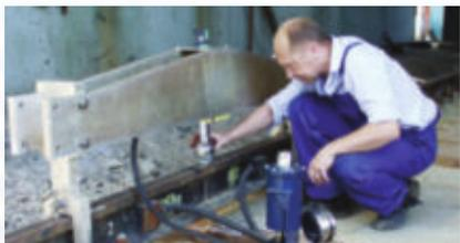
Устройство ВПУ-12.5 предназначено для настройки, калибровки и поверки весов вагонных рельсового типа ВД-30 с помощью эталонного датчика класса точности С5 (Германия). Методика поверки весов ВД-30 с помощью ВПУ-12.5 утверждена Росстандартом. Устройство аттестовано как эталон единицы массы 4-го разряда.
